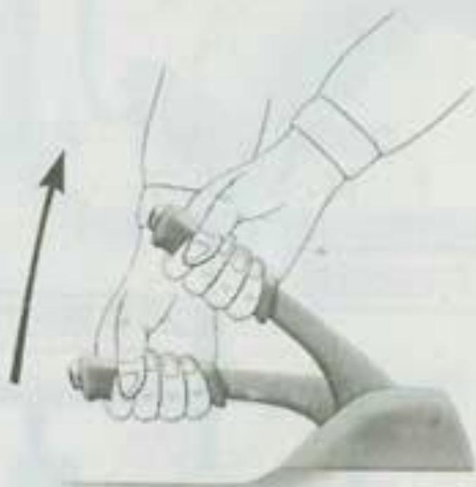
② 转动钥匙使发动机停止。停在上坡时挂入低档，停在下坡时挂入倒档
