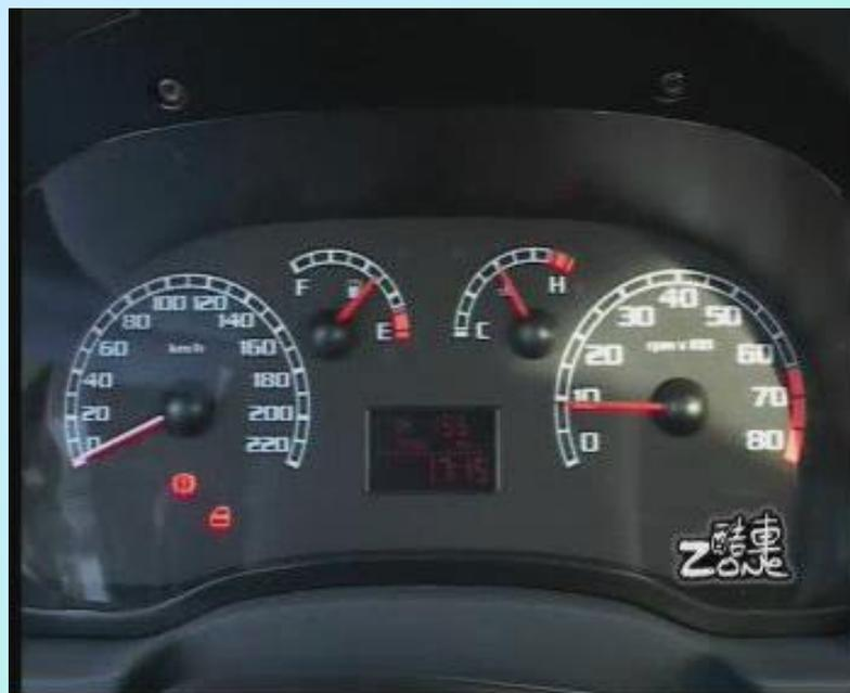
24、转速表：显示发动机曲轴转速的。
