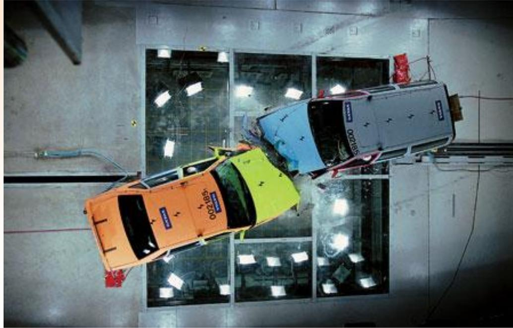
试验表明，速度达到50公里时，1.5吨的车体发生碰撞冲击，钢板厚薄差0.1毫米根本不起作用，平面抗冲击能力对安全性基本没有影响。
